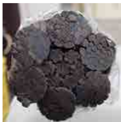
ワイヤーロープの断面 （直径47.5mm）
